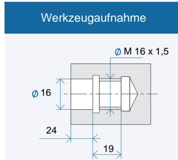
Werkzeugaufnahme: Passbohrung mit Plananlage nach GMN Standard
