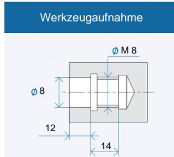
Werkzeugaufnahme: Passbohrung mit Plananlage nach GMN Standard
