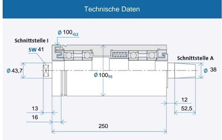
Maximale Drehzahl  $n_{max}$  [min<sup>-1</sup>]\* für Lagerausführung:
