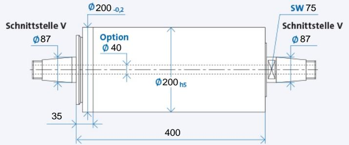
Bohrung durch die Spindelwelle ist Option
