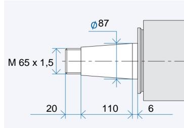
Werkzeugaufnahme: Passbohrung mit Plananlage nach GMN Standard
