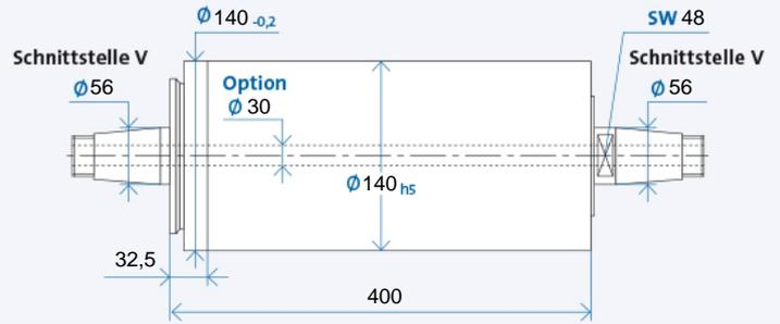
Bohrung durch die Spindelwelle ist Option
