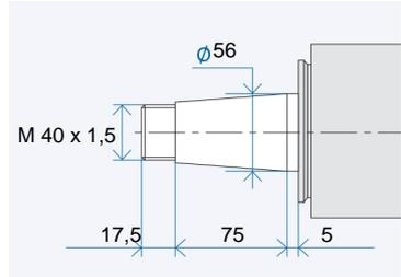
Werkzeugaufnahme: Passbohrung mit Plananlage nach GMN Standard
