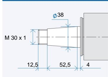
Werkzeugaufnahme: Passbohrung mit Plananlage nach GMN Standard
