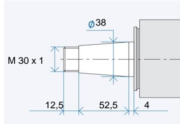
Werkzeugaufnahme: Passbohrung mit Plananlage nach GMN Standard
