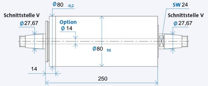
Bohrung durch die Spindelwelle ist Option
