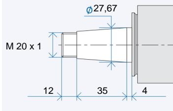
Werkzeugaufnahme: Passbohrung mit Plananlage nach GMN Standard
